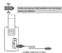
Le port USB peut être utilisé pour recharger votre appareil mobile jusqu'à 5 V, maximum 500 mA CC, en utilisant un câble USB. Câble USB vendu séparément.
