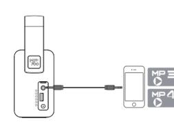
Connecter à la source à l'aide du câble auxiliaire 3.5 mm inclus
